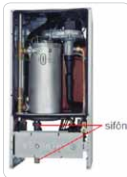
Obr. 3 Kondenzačný kotol so sifónom brániacim úniku spalín do okolia
